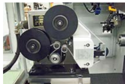
フィルム研磨ユニット取付 研磨加工(FM機ベース専用機)
