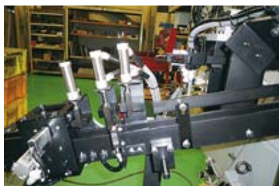
全長 ポカ除け装置(GTセンサー)
