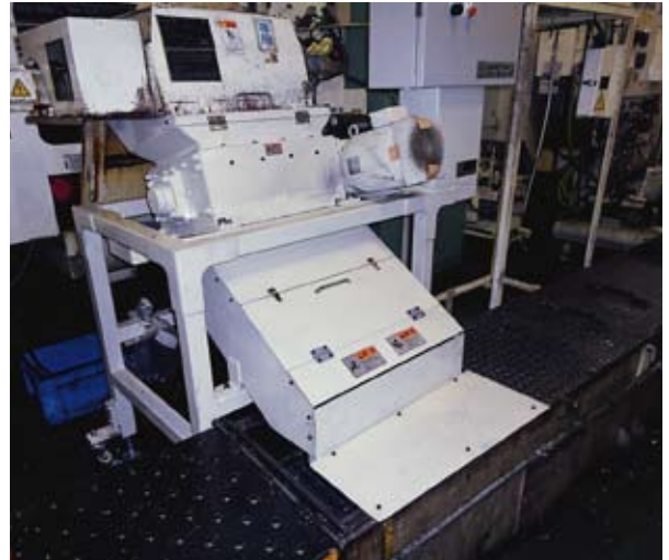
切粉破碎機SKE-150HL-60-400R 設置例
