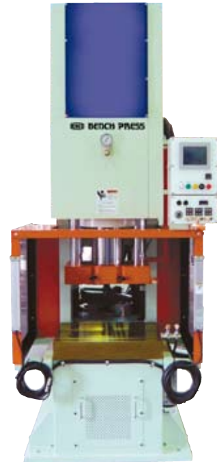
50TONカシメ用 KPH-50M (E) 電動メカニカルストッパー付
