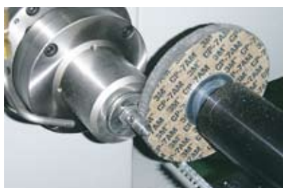
バリ取り加工 (油圧単能機ベース専用機)
