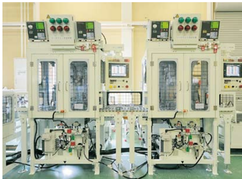
生産ライン内洩れ検査装置
