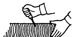
② 拆下冷风管的槽，用剪刀或斜口钳剪断。
